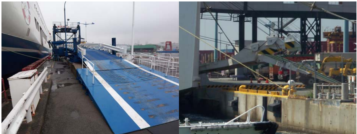
圖 22：側開 RORO 客貨船之車輛上下調整板
