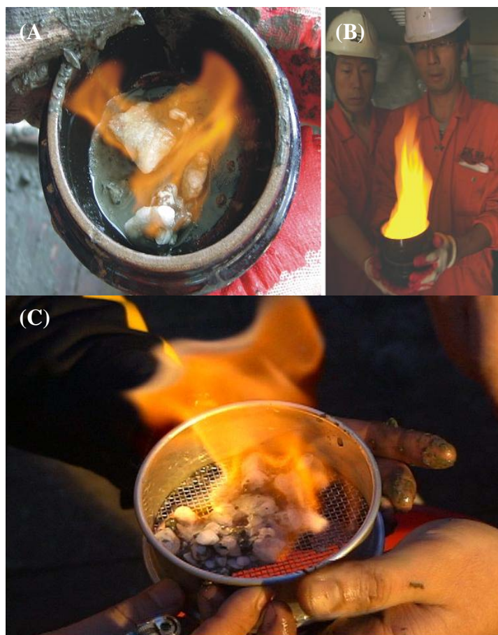
圖 4-8、韓國在東海海域郁陵盆地海域以活塞岩心（A、B）及鑽井岩心（C）取得天然氣水合物標本點火燃燒的情形（韓國產業資源部網頁之 2007 年 6 月 25 日與 2007 年 11 月 11 日新聞稿資料）。
