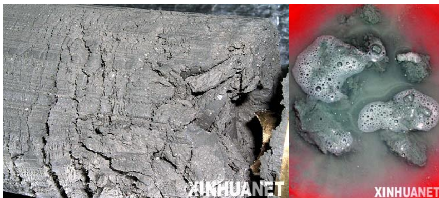
圖 4-10、神弧海域地區鑽探所採得之含天然氣水合物標本 (A) 及在水中分解冒氣 (B) 之照片（新華網電子報）。圖 (A) 之泥質岩心中呈分散狀的白色晶粒，就是天然氣水合物。
