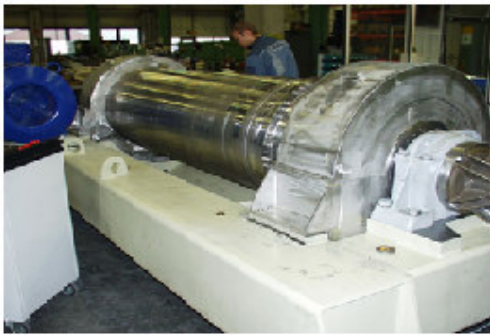
圖三、離心機在 Flottweg 廠區中組裝之情形。
