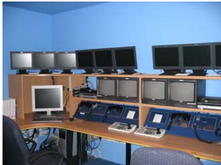
圖八、360 度環景式操船模擬機控制室
