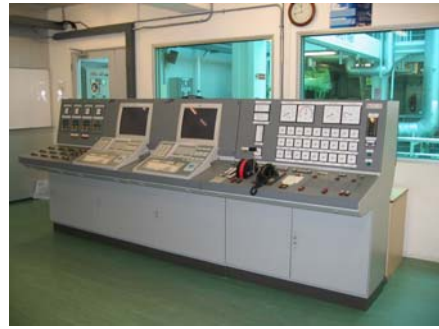
圖四、結合模擬機與實機的機艙控制
