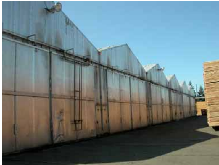
全自動化設備的乾燥窯
