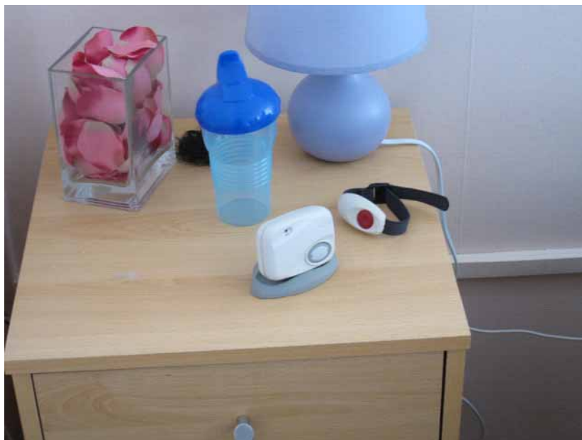
圖 18 被照護者臥室中之跌倒監測器、緊急呼叫按鈕、離床照明燈
