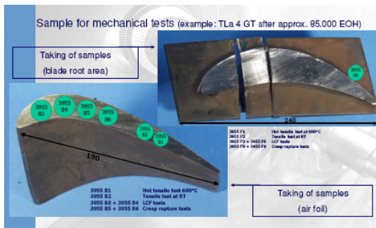
圖 3-42 葉片根部抽樣片： 機械拉力測試 潛變測試、低週疲勞測試
