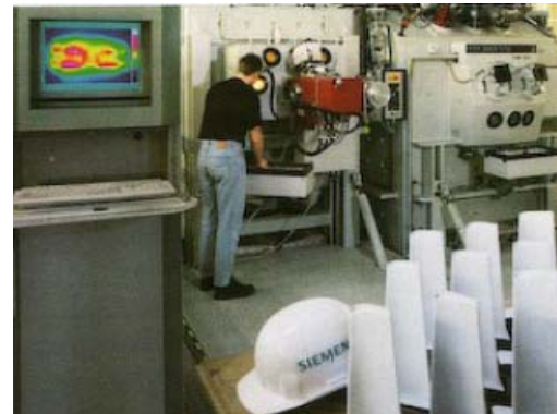
圖3-14 EB-PVD U$10 Million (Preheat 1000°C兩側 , 3000°C凝結)
