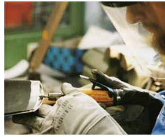
Cut wire Shot Penning 較亮 葉根緣 Overspray 要磨除
