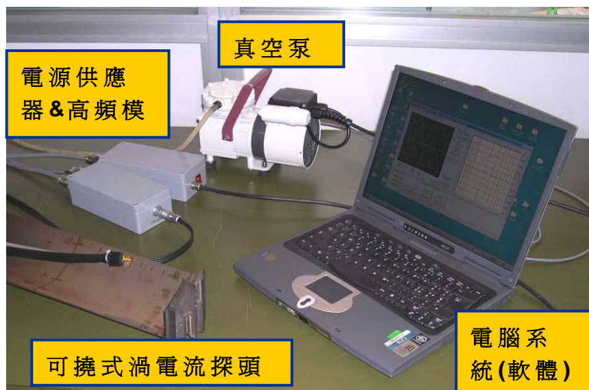
圖2-1 氣渦輪機葉片多頻掃描渦電流檢測系統
