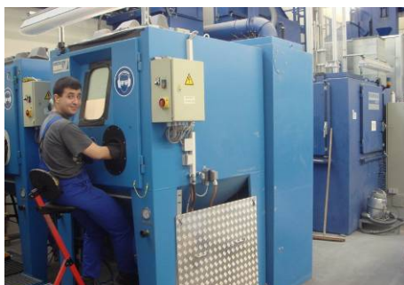
圖 3-6 人工研磨視窗，貼附可更換保護膜，防止磨損
