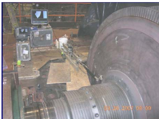
圖 19. NDT of Steam Turbine 鳩尾槽及Disks之相位 陣列超音波檢測。
