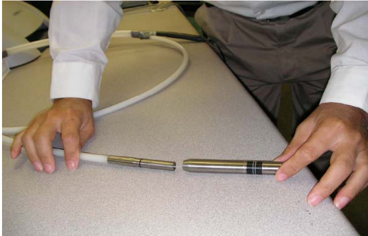
圖 6. 可拆式探頭-可減少探頭之消耗及備品
