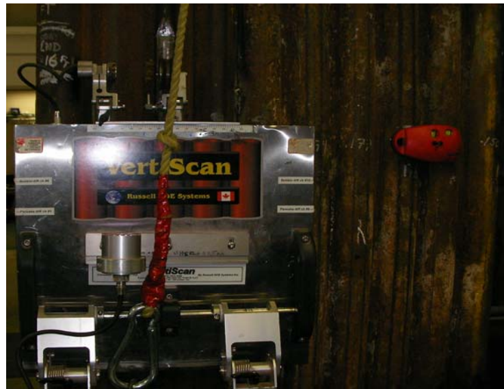
圖 15. 自動爐管掃描設備：一次可掃描 5 支管子
