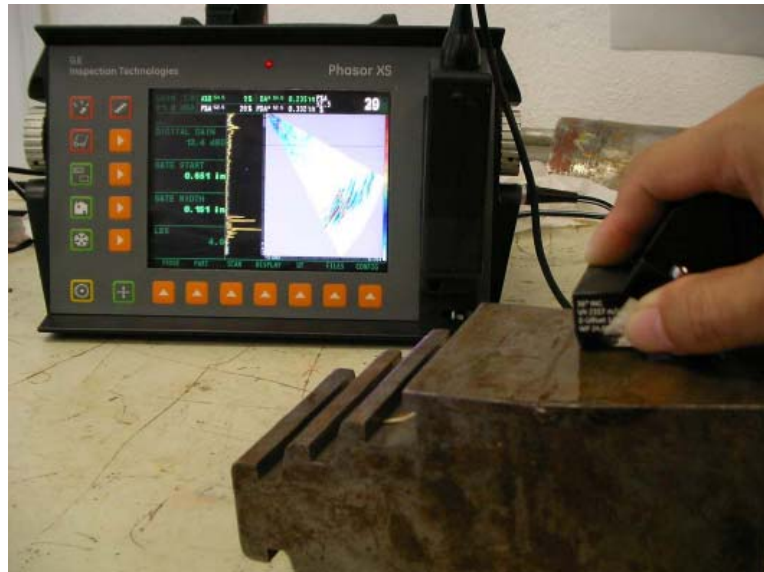
圖 3. Disk (葉根槽位之 PA 測試)
