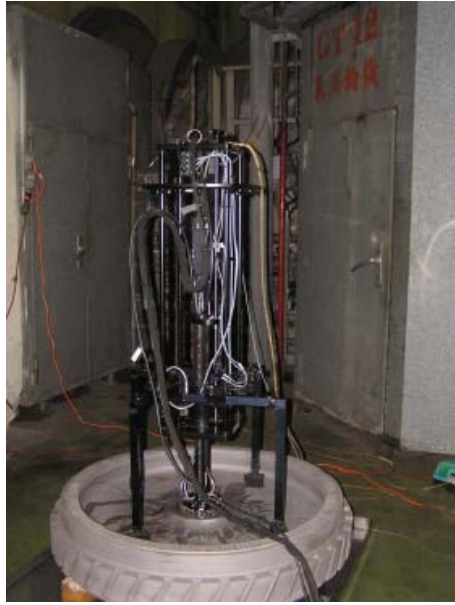
圖 26. 傳統 UT 之 C-Scan 檢測掃描架
