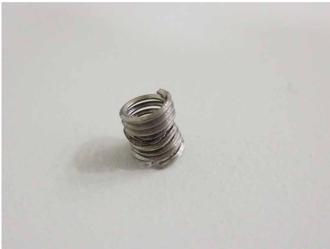
圖四十二、故障的螺紋線圈
