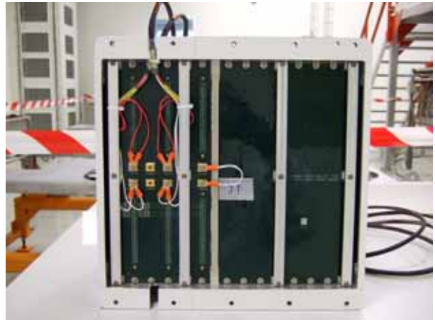
圖八、JT 最終電源接頭螺絲安裝
