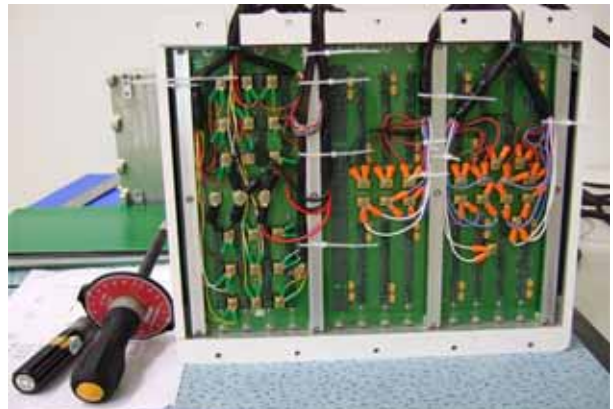
圖四、安裝 U1 最終電源接頭螺絲
