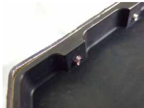
圖二十二、螺紋線圈故障二
