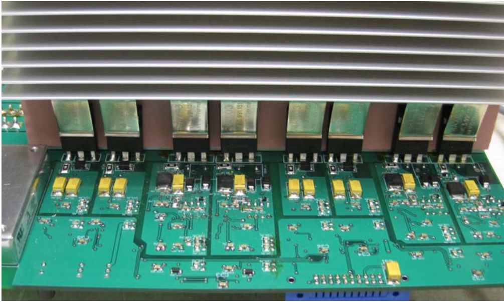
圖 4-9：AUX IGBT(20N60A4D)及 MAIN MOSFET(6B045)組裝
