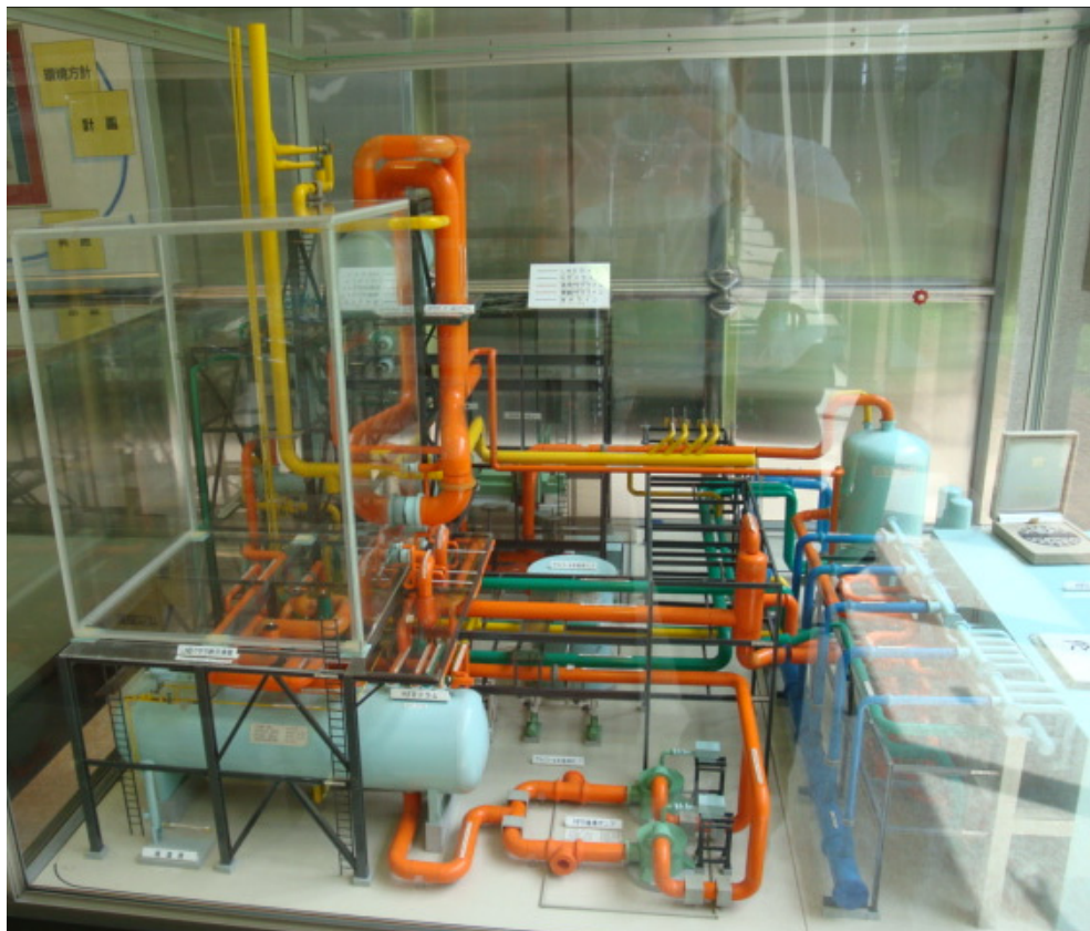
NEGISHI 接收站 MF Rankine 冷能發電工廠 1 : 30 縮圖
