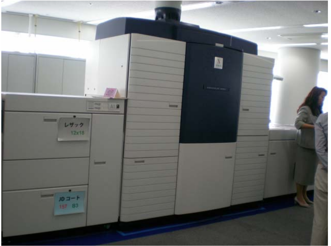
圖 3-1 iGen3 彩色數位印刷機照片
