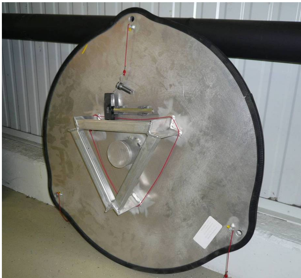
圖 4.33 舊型 HUB 入口門板
