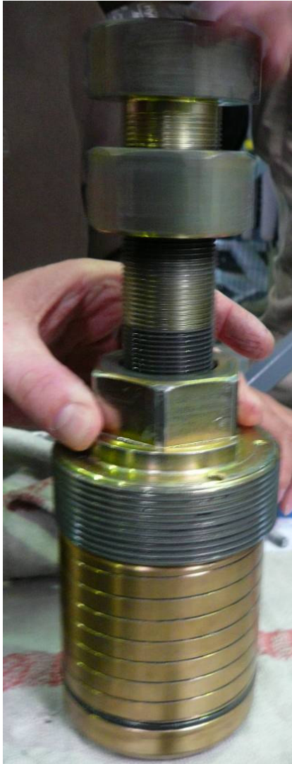
圖 4.8 BRAKE PISTON 組裝示意圖
