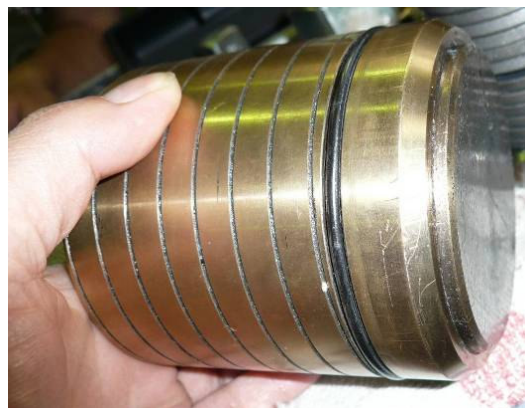
圖 4.11 BRAKE PISTON 底部耐磨合金
