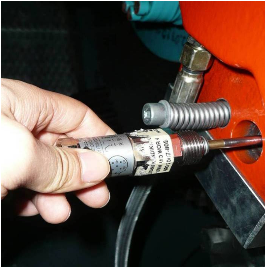
圖 4.21 拆下來令片之前須先取出厚度偵測開關
