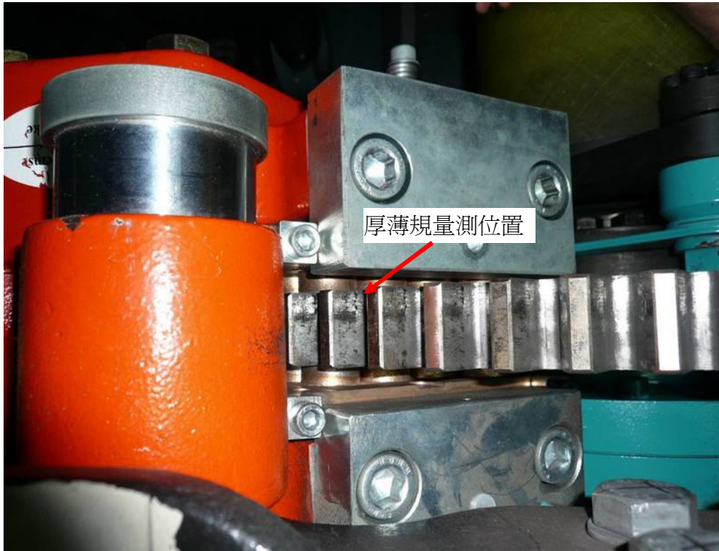
圖 4.22 以厚薄規量測來令片間隙
