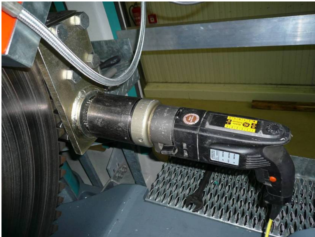
圖 4.13 放鬆油壓煞車後以電動工具帶動轉軸
