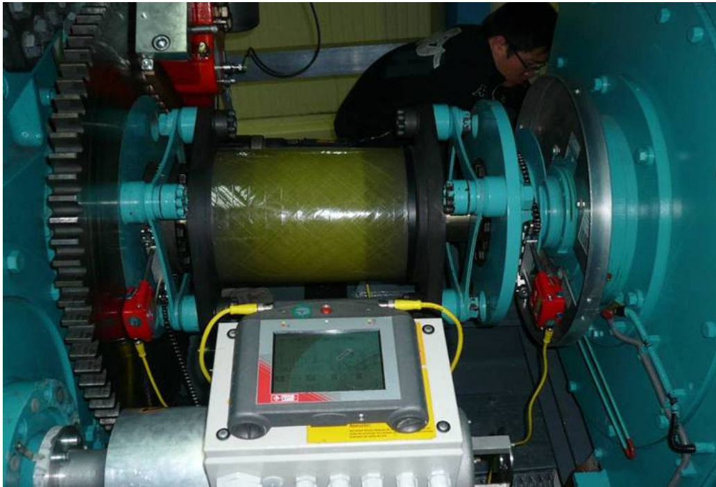
圖 4.12 將雷射對心儀架設於撓性聯軸器兩側轉軸
