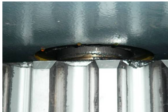
圖 4.9 BRAKE PISTON(上)與 YAW BEARING (下)之接觸面
