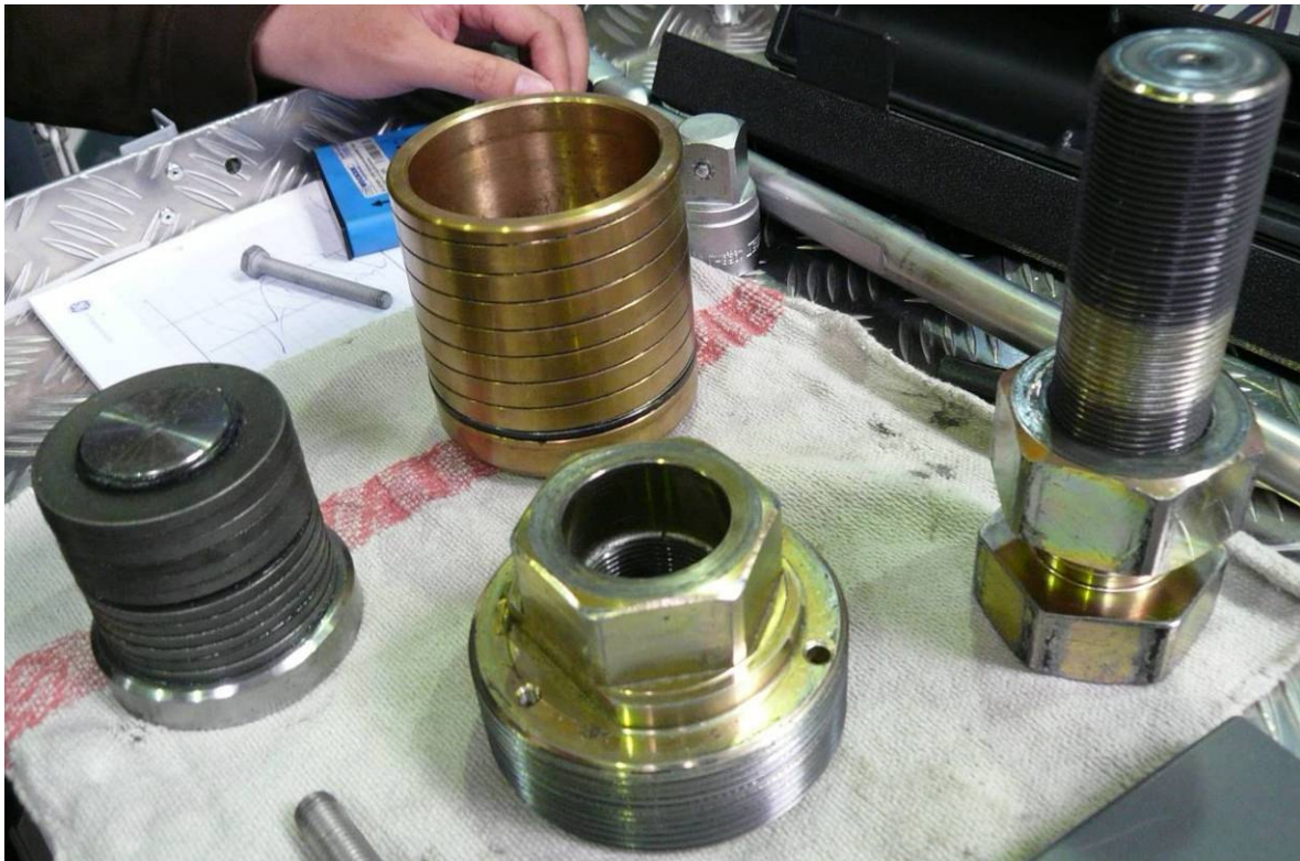
圖 4.6 BRAKE PISTON 分解示意圖
