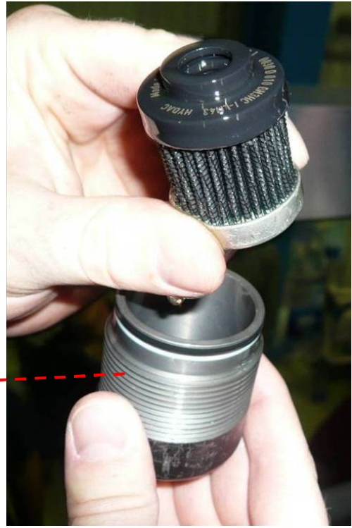
圖 4.20 拆下液壓油之濾網檢查是否阻塞
