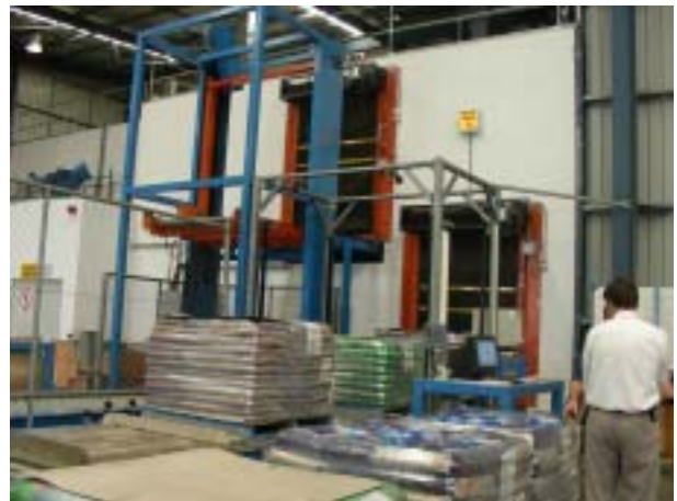
圖 94. 射線輻射處理設施內待處理之物品
