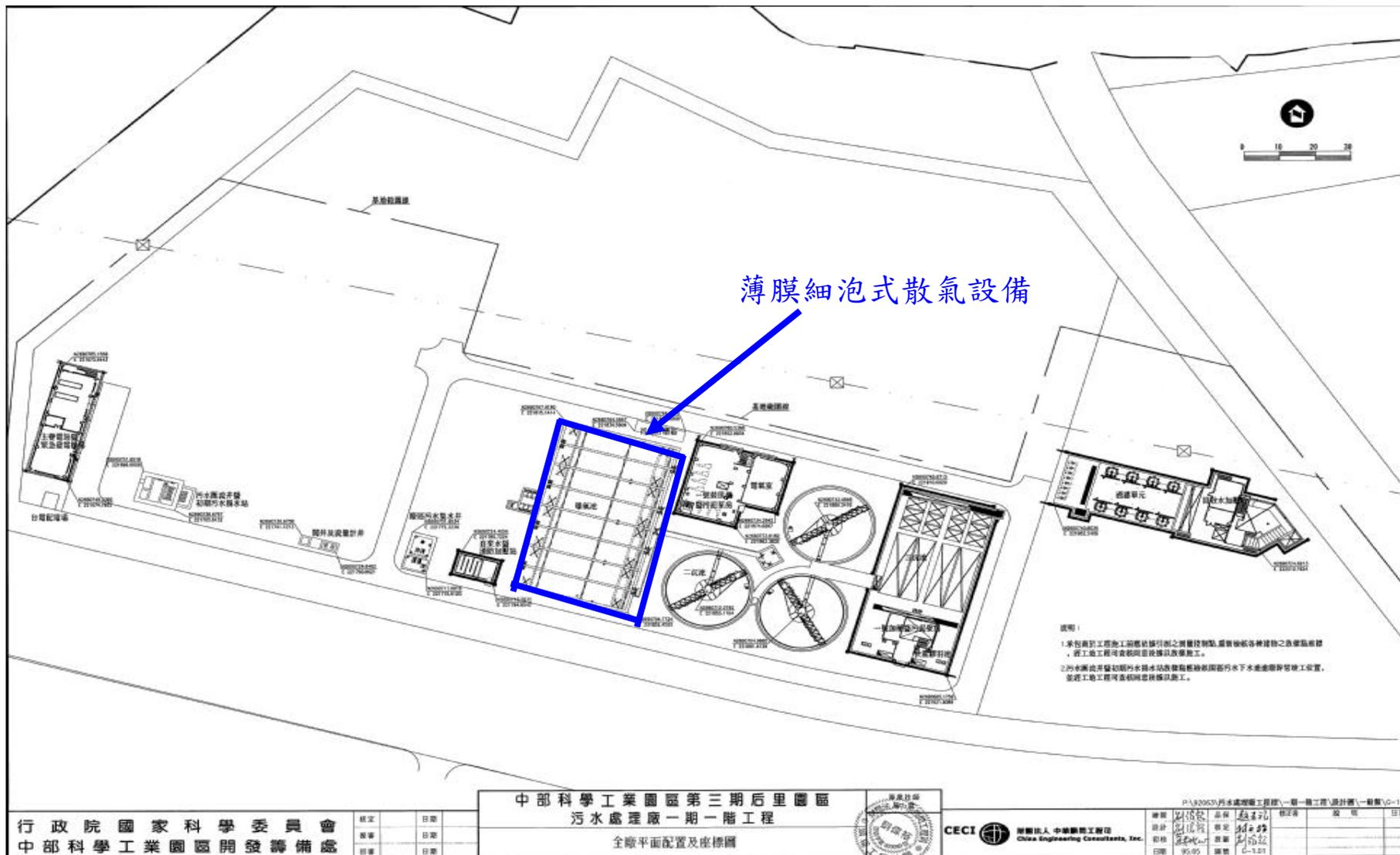
圖 6 薄膜細泡式散氣設備安裝位置圖
