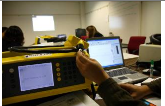
利用 Sample 做 GC/MS 15 min Loop 方法
