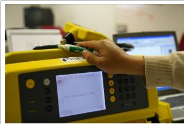
利用白板筆做 GC/MS 15 min Loop 方法試驗
