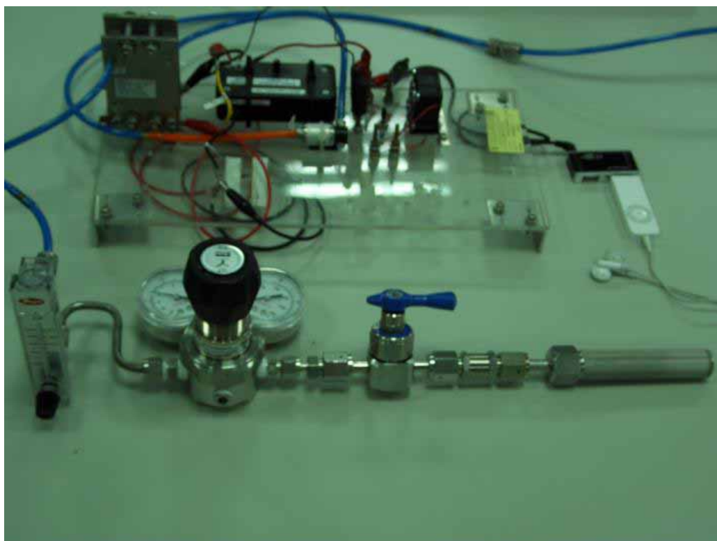
圖六、將儲氫匣連接調壓閥、流速控制器、PEMFC及電壓控制器，即可推動iPod Shuffle播放音樂
