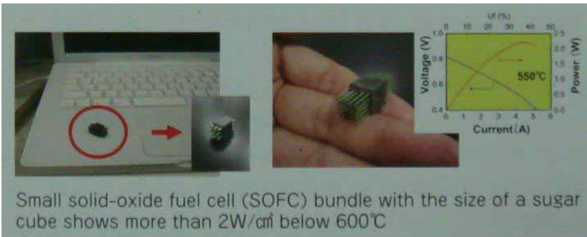
圖十一、日本NEDO研發成果之管狀單電池及電池模組，單元NiO-GDC/GDC/LSCF-GDC電池採用0.8mm及1.6mm直徑，可輸出世界最高之功率密度 1\text{W}/\text{cm}^2 ( 570^\circ\text{C} )，或 2\text{W}/\text{cm}^3 ( 600^\circ\text{C} )
