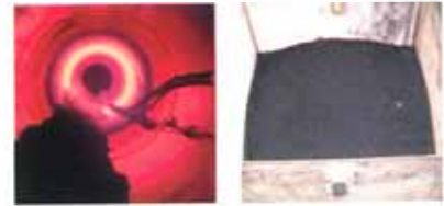
圖二十八、韓國Carbon Nano-material Technology公司量化生產CNT的設備，(a)圖為製程系統示意圖，(b)圖顯示其設施外觀以及生產的CNT
