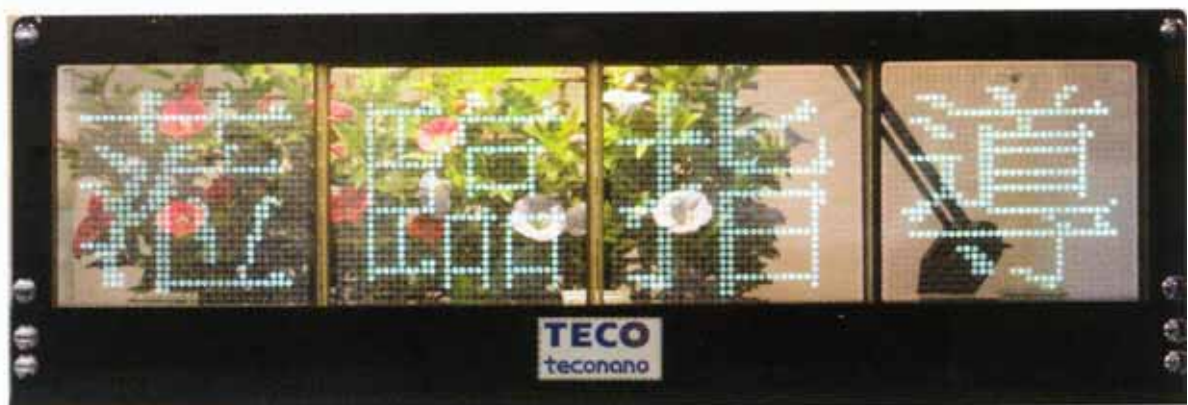
圖二十七、台灣東元應材公司利用CNT製作的透明廣告顯示牌
