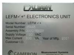
核三廠飼水超音波流量計儀控盤
