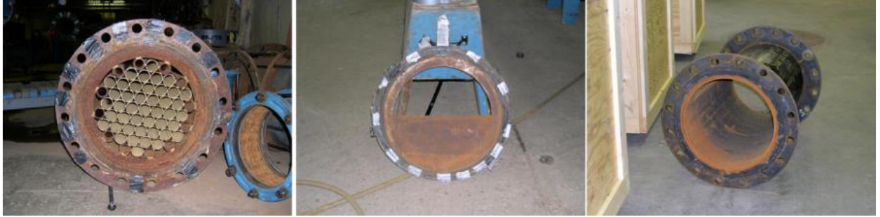
▲圖 3 水流流譜測試管件：流量直管(左)、半月型檔板(中)、流量空管(右)
