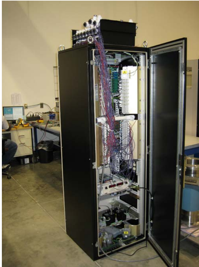
▲圖 16 在 UFM 電子儀控盤使用零流量測試套件測試
