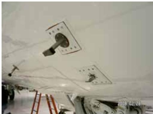
Gulfstream-5 型觀測飛機腹下方裝設之水滴粒子觀測設備
