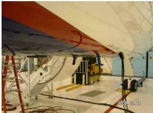
Gulfstream-5 型觀測飛機腹下方裝設之其他觀測儀器
