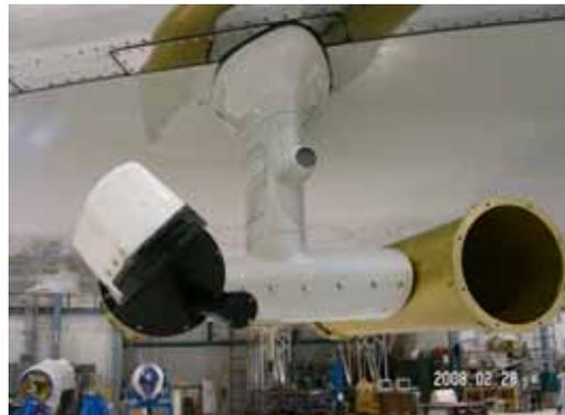
Gulfstream-5 型觀測飛機機翼下方裝設之雲物理觀測儀器
