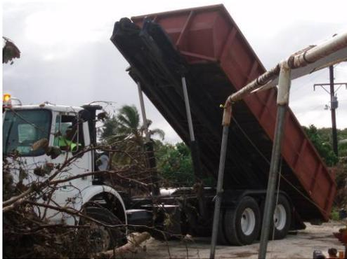
垃圾（拖運母）清運車進場後，將子車卸下操作情形
