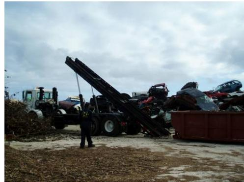
垃圾（拖運母）清運車，將子車卸下後脫離情形
