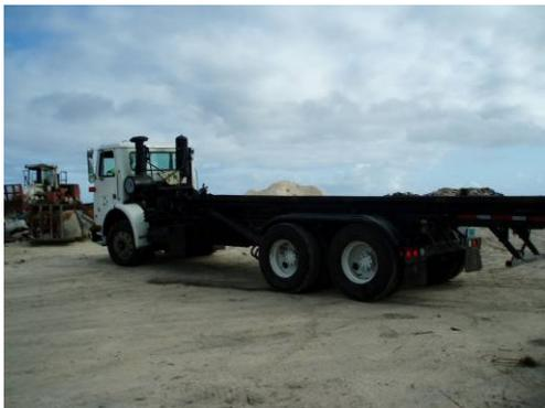
垃圾（拖運母）清運車，將子車卸下後空車情形
