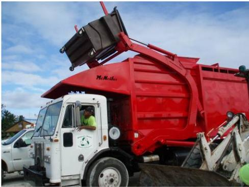
小型垃圾收集子車被吊起來後再將垃圾翻轉倒入垃圾清運車內
