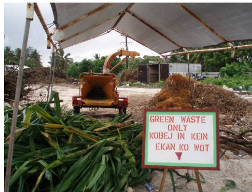
圖 20 掩埋場進行綠色廢處理再處理操作成屑狀
