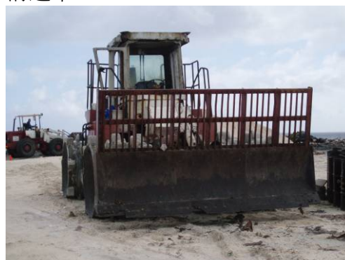
圖 16 掩埋場配置垃圾壓實推平機
