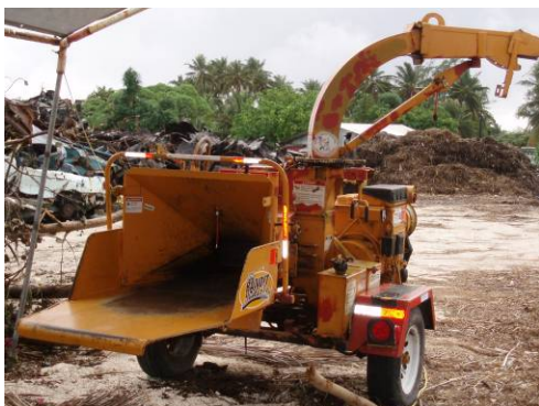
圖 21 掩埋場綠色廢棄物再處理機器—小型軋碎機
