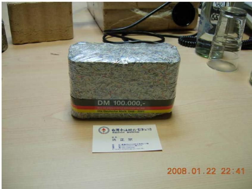
圖陸-7 10 萬馬克廢紙鈔之 60mm X 150 mm 擠壓成型樣品
