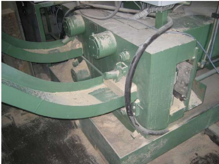
圖陸-5 擠壓成型機擠出木屑塊
