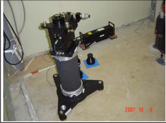
先架設絕對重力儀底座 (Superspring)
