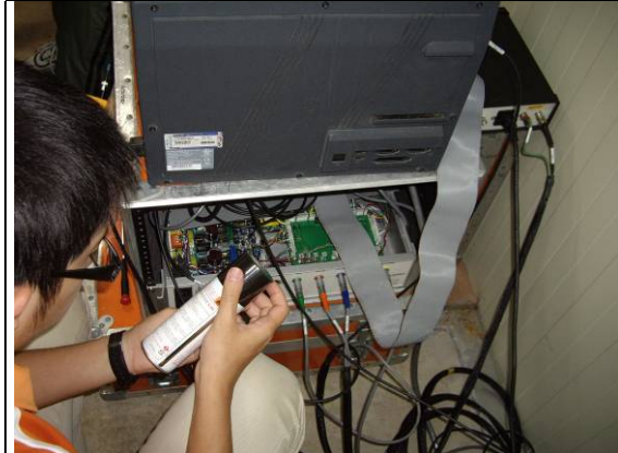
使用電子接點清潔劑處理電子接點
