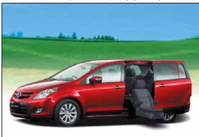
圖 2：升降式座椅。取自 http://www.welfare.mazda.co.jp/mpvsec/
