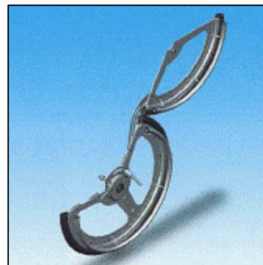
圖 8：可上掀式輪圈。取自 http://www.nedo.go.jp/informations/koubo/190416_2/besshi2-1.pdf
