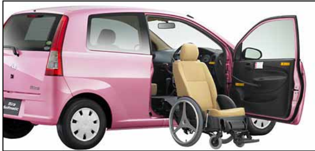
圖 3：可移動之汽車座椅。取自 http://www.daihatsu.co.jp/showroom/lineup/tokusha/friend_m_self/index.htm
