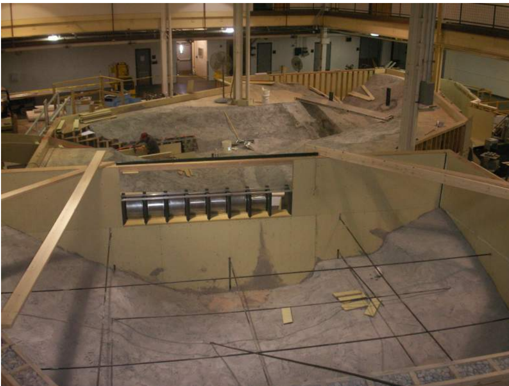
照片六 美國墾務局水資源研究試驗室(WRRL)以木材製作模型
