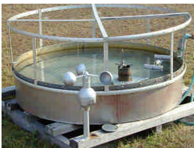
泰國氣象局地面氣象觀測站所使用之蒸發皿，皿旁附有風速觀測計，能更準確得到近地面之風速。
