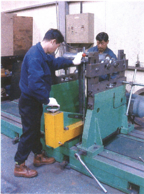
開始見證 carrier roller 動平衡試驗
