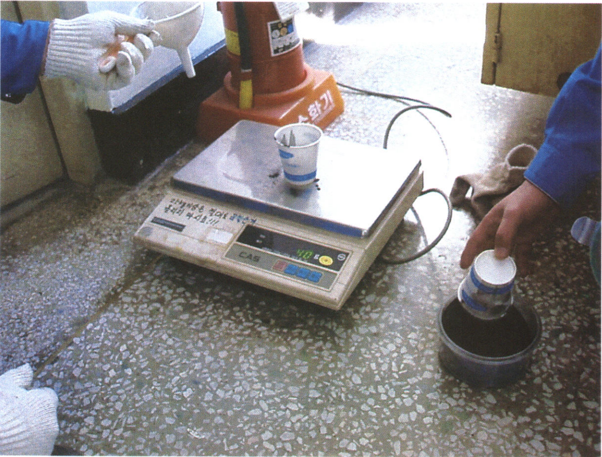
準備進行防污染試驗，先測量杯子重量(5g)
