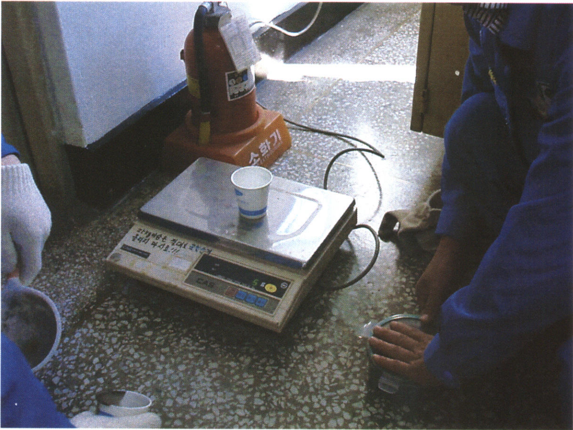
準備進行防污染試驗，先測量杯子重量(5g)
