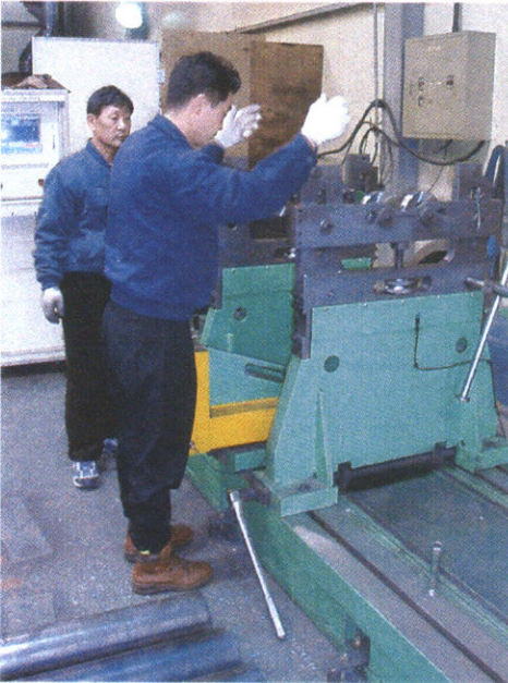
先測量 roller 長度後再進行機台調整作業
