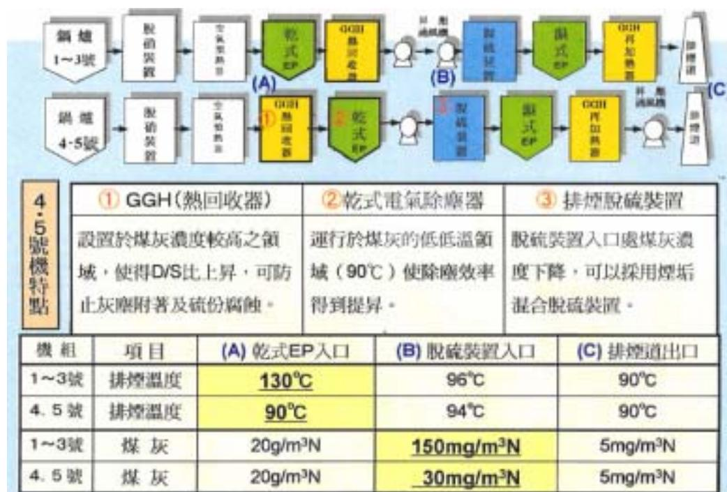
圖 13 排煙處理流程及排煙濃度
