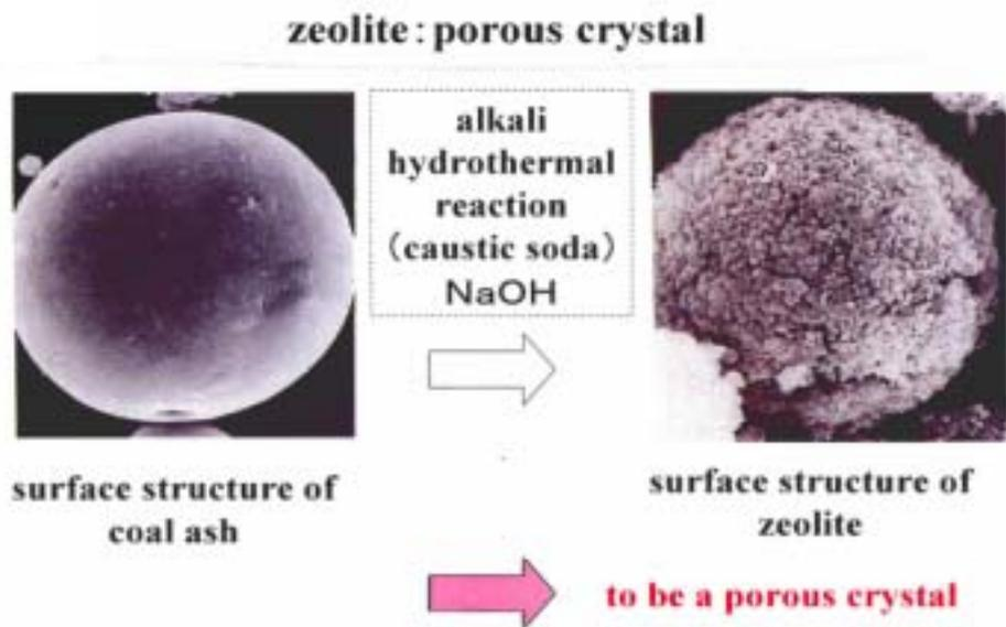
圖 14 多孔隙的沸石表面
