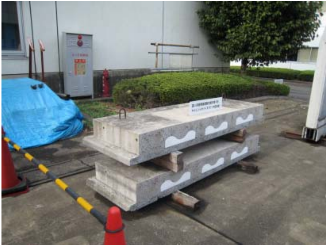
圖 25 熊谷組所開發之隔音樓板材
