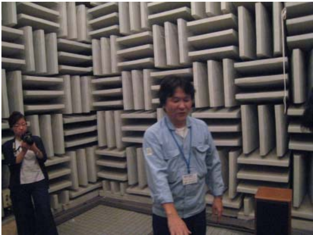
圖 24 音響試驗室(無響室)
