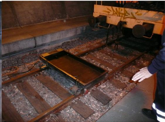
圖 28：隧道內模擬火災之火盤
