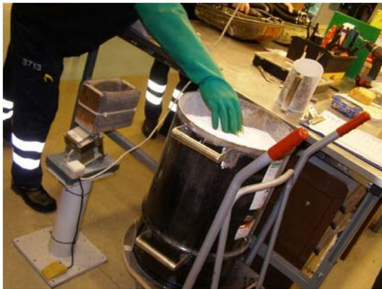
圖 10：維護人員更換循環式呼吸器藥劑情形
