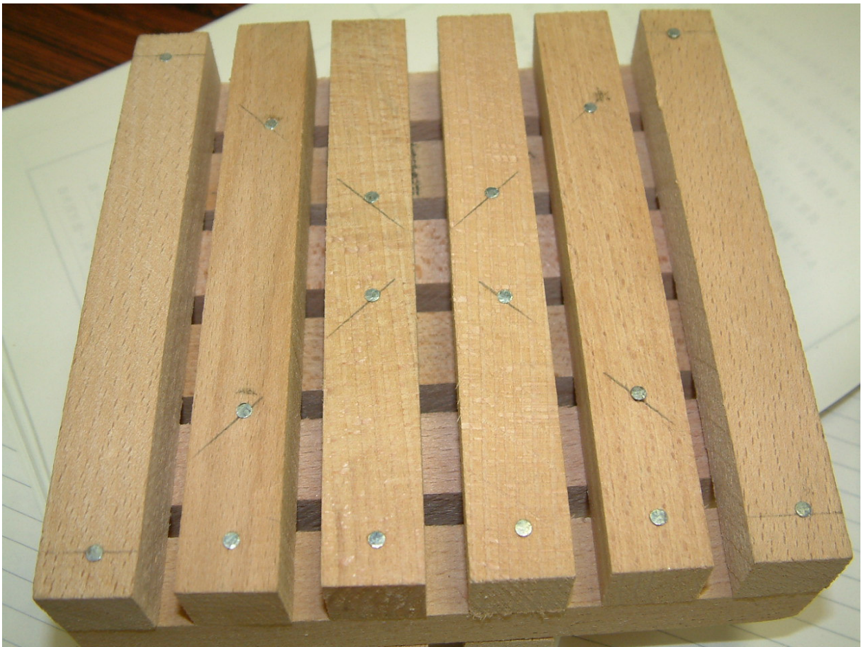
圖 18、燃燒木堆測試之木堆(火災安全等級 B 測試用)
