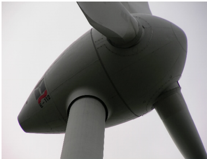
(左) Enercon E-112 風力機主體 (無齒輪箱設計, 額定發電功率: 4.5/6 MW) (右) Enercon E-112 整機 (葉片直徑 113 m; 塔架高度 125m)
