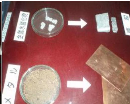
圖 8. 金屬及金屬鹽類再利用製成銅片及鉛塊
