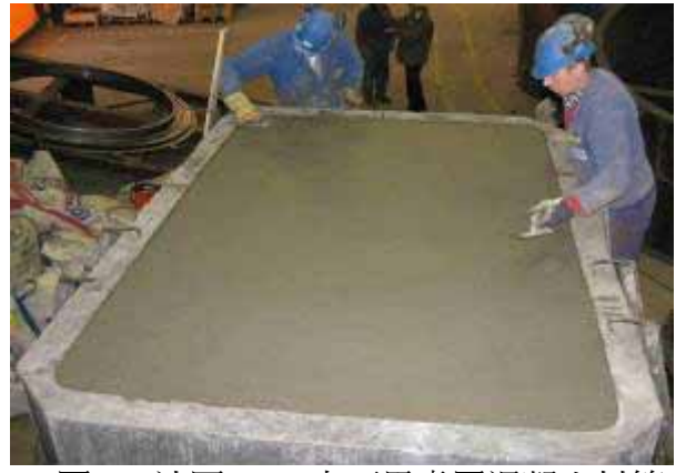
圖 7、法國 EDF 之石墨處置混凝土封箱
