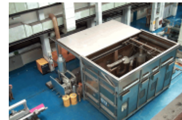
圖 26、德國 EWN/Greifswald 檢整除污設施：熱切割設備
