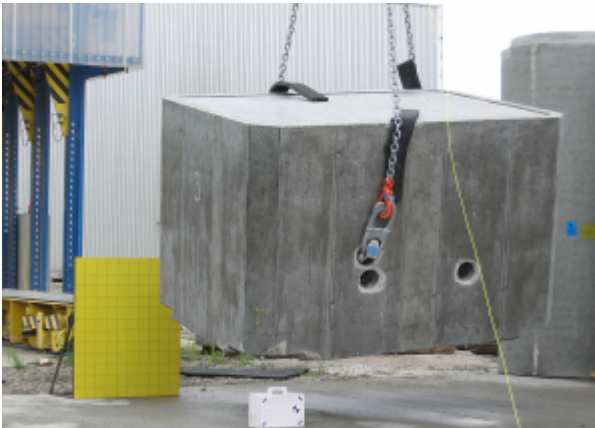
圖 8、法國 EDF 之石墨貯存箱墜落測試
