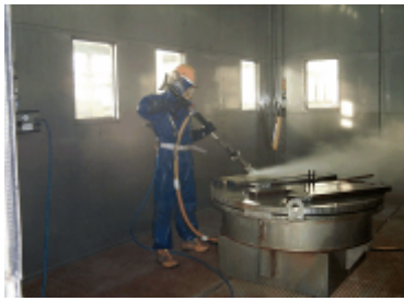
圖 23、德國 EWN/Greifswald 檢整除污設施： 高壓水柱操作
