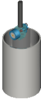
圖 12、日本 FUGEN 電廠 內管水刀切割設計
