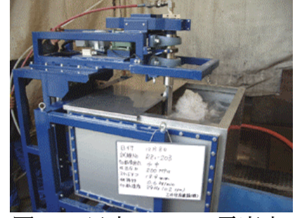
圖 14、日本 FUGEN 電廠水刀 切割實驗
