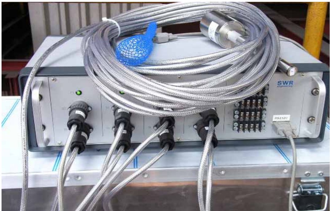
圖21.SWR (德) 多頻道粉煤流量測儀在現場進行測試
