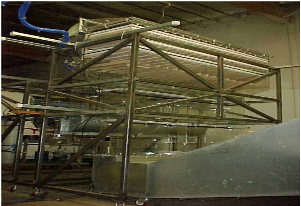
圖11.FERCo 冷流場模擬模式(Cold Flow Modeling)
