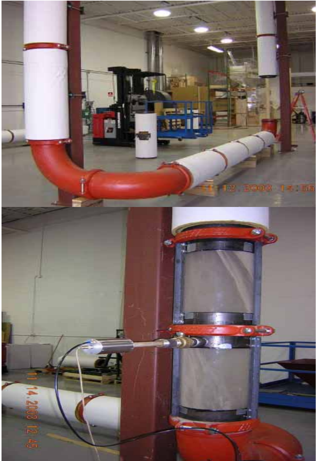
圖15 .EPRI 的Coal Flow Loop實驗裝置 (下圖可明顯觀察到彎管下游繩索現象)
