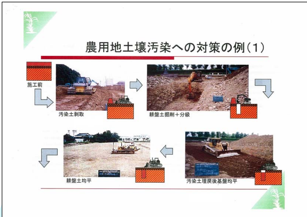
圖 3.3-2、土壤整治方法示意圖-上層污染土壤與下層乾淨土壤置換
