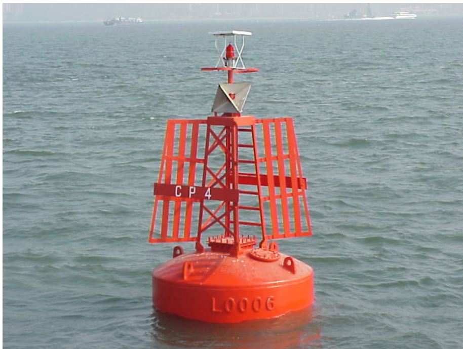
這是左舷燈浮，形狀是罐狀，顏色是紅色，燈光也是紅色，船舶進港時應將其擺於左舷通過。
