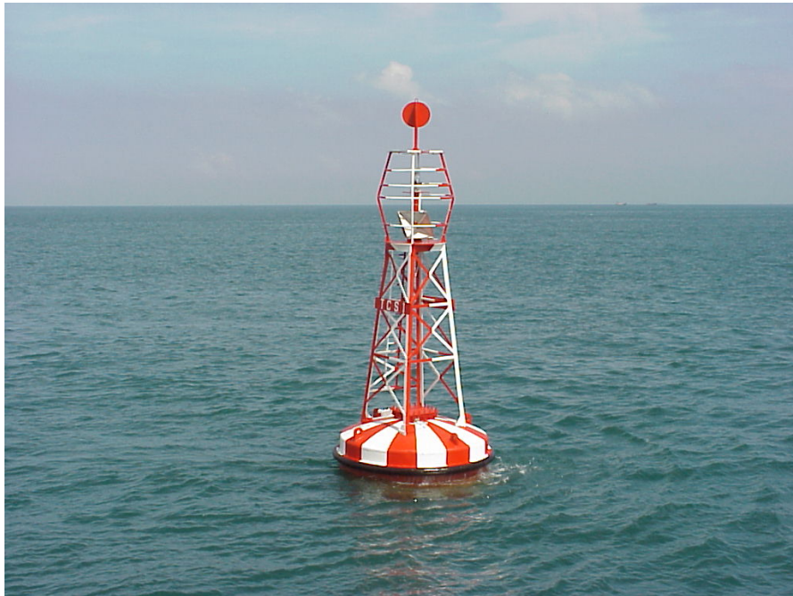
這是表示安全水域之燈浮，頂標為一個球形，顏色為紅白相間直條紋，燈光為白色頓光或長閃光，豎立於航道中央，表周圍有航道可通，這是設於外港空曠水域之燈浮，其上設有雷達反射器以增強被雷達遙測。
