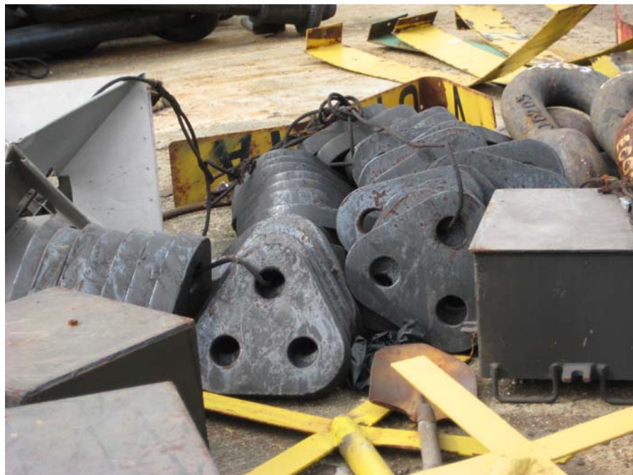
這是浮筒下方與錨鍊間之三角環，藉著三角環的作用，錨鍊與浮筒間 才不會有纏絞之虞
