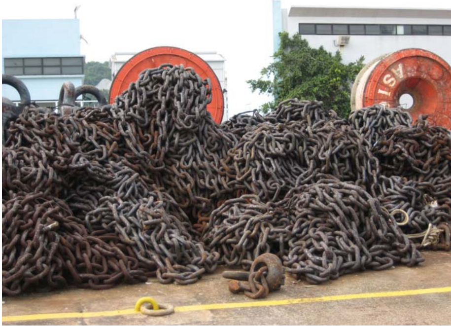
這是拖回置於工場的錨鍊，經檢測後如鍊徑耗損達規定之標準便須全條 換新
