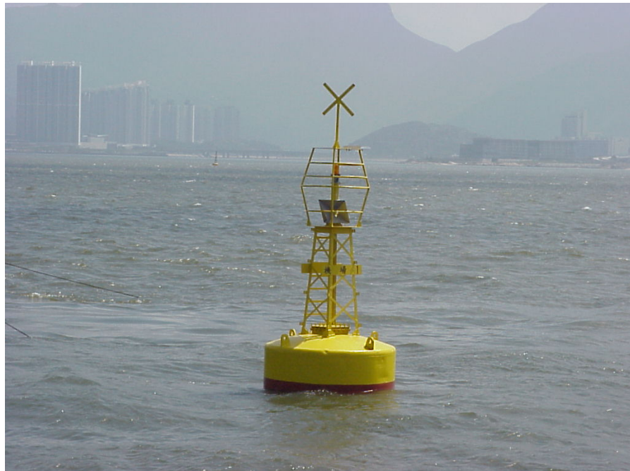
特殊用途浮標，顏色為黃色，燈光為黃閃燈，用途依香港海事處航行佈告個別公告，本燈浮為施工用燈浮。
