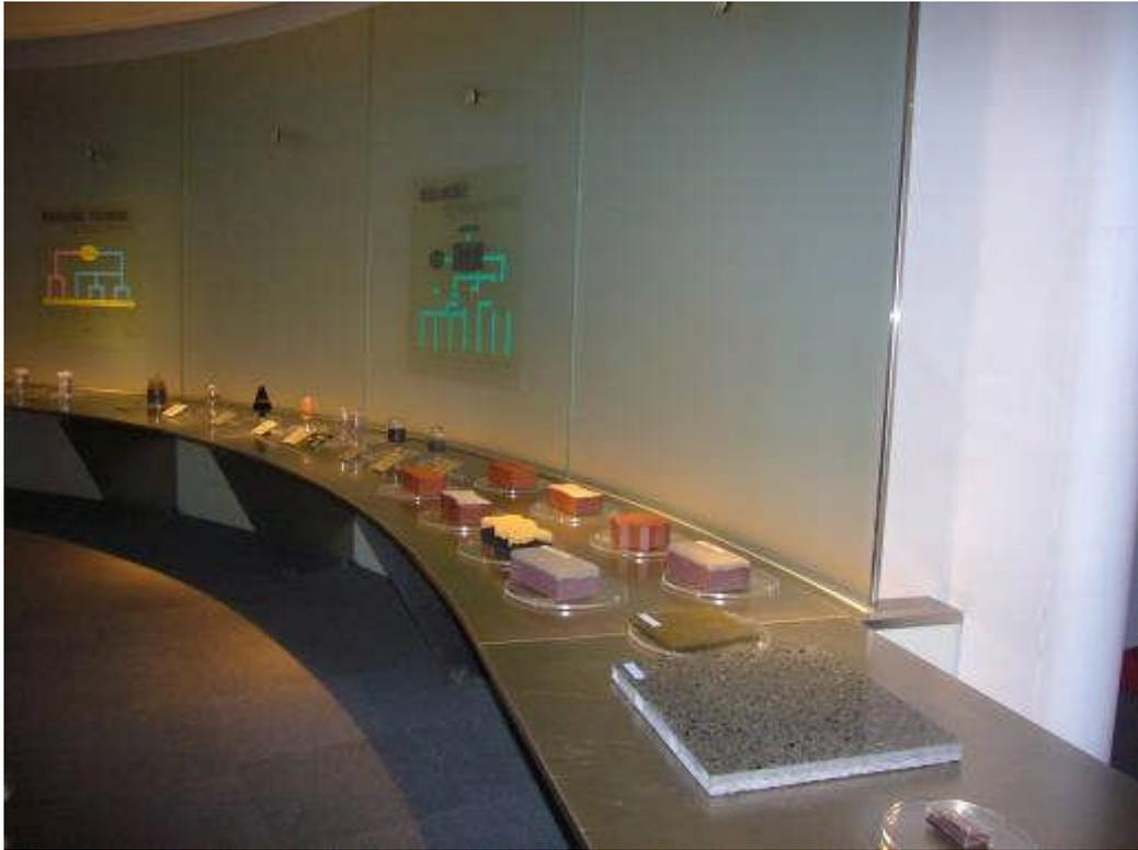
虹下水道館污泥製品展示區(步道磚、輕質骨材、陶製品原料等)
