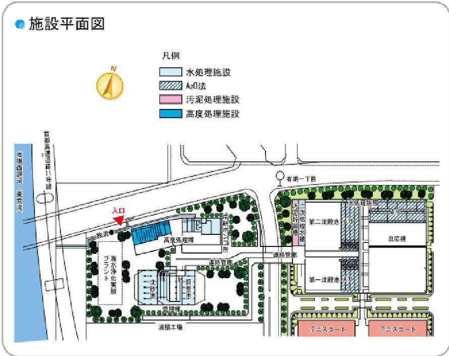
図 2 有明水再生中心平面配置図
