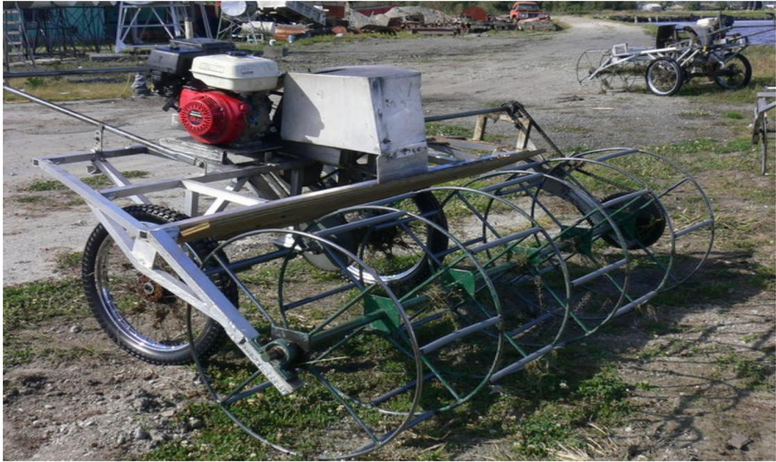
圖十六、蔓越莓滾軸式攪拌採收機。(張定霖攝於 Fraser River)
