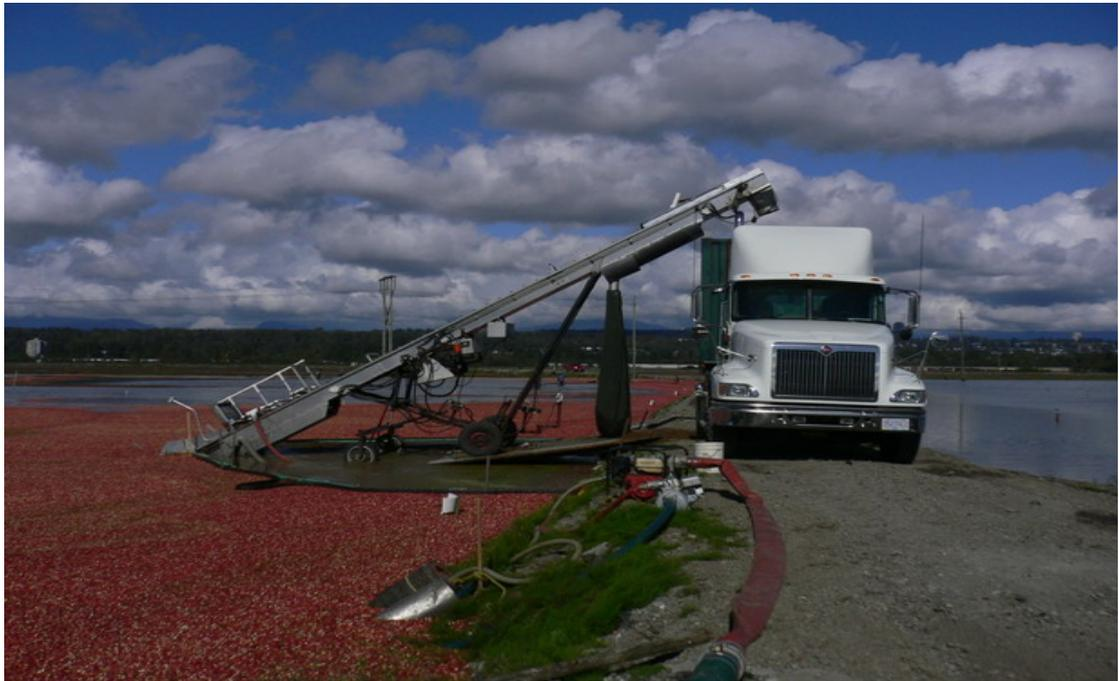
圖十八、蔓越莓果實脫落後漂浮於水面，通常容易因風向漂浮至下風處，再經由攔截索圈圍集中，並以輸送帶收集裝運（張定霖攝於 Fraser River）。
