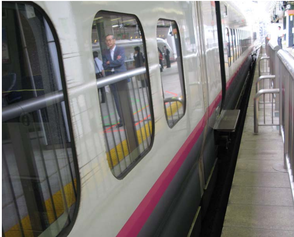
照片 21 停靠在東京車站之 E3 系「小町號」(こまち)列車，月台與列車間隙較大。月台設有護欄、列車配備有登車踏板。
