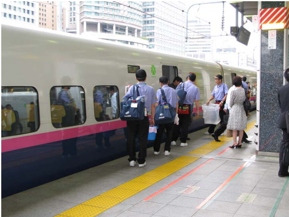
照片 23 同照片 5 說明，除月台間隙較小外，月台上未設置護欄
