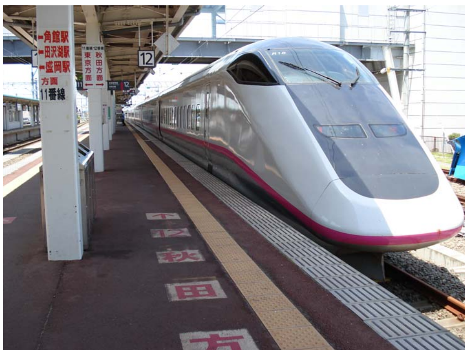
照片 24 停靠在秋田新幹線大曲站之 E3 列車，月台與列車間無間隙。
