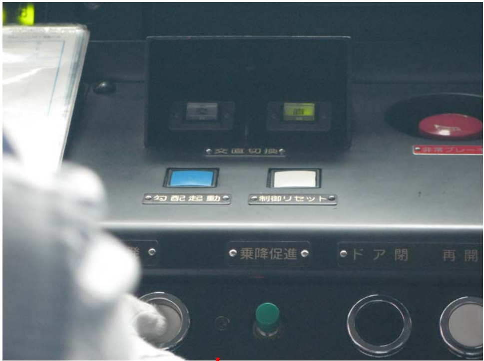
照片 6 TX-2000 系電車可切换 交、直流供电
