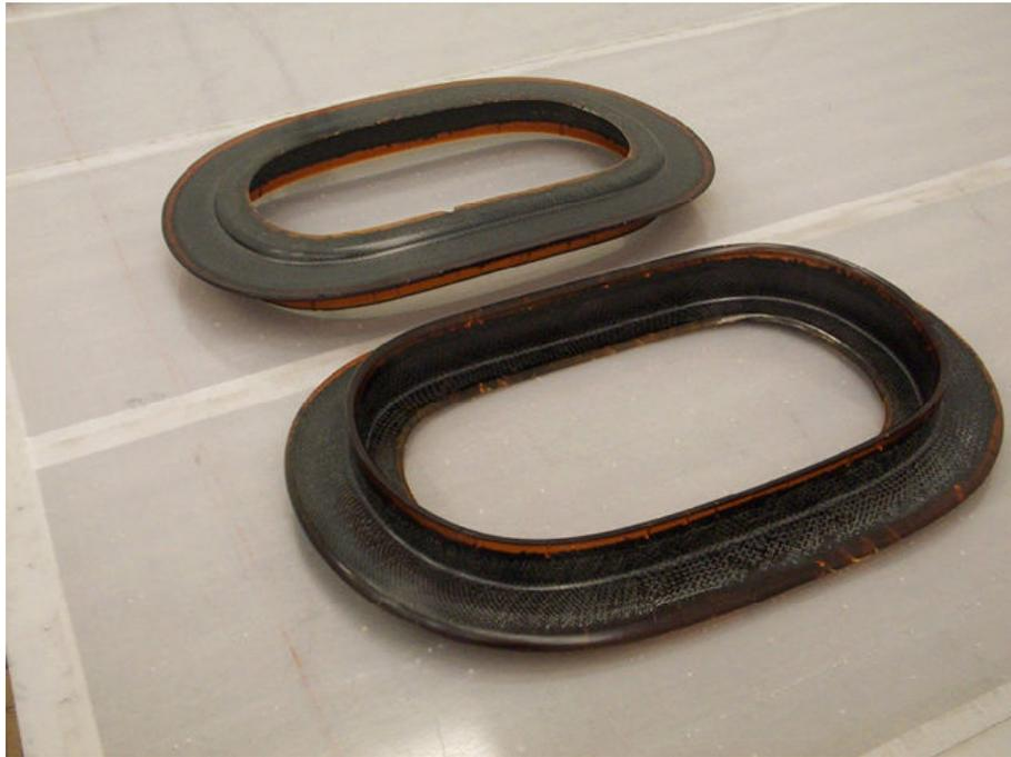
圖 25、可溶性纖維材料應用於窗戶骨架製作
