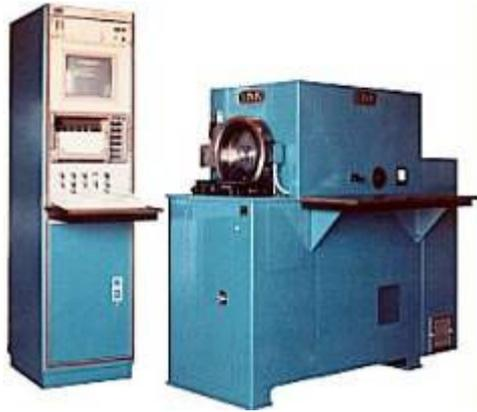
對煞車系統之慣性矩試驗機(Dynamometer)，如下：
