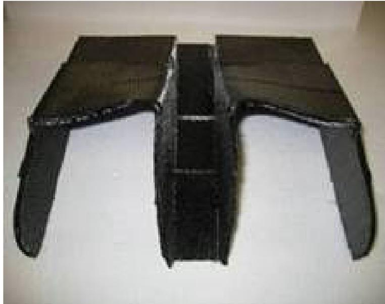
圖 16、可溶性纖維材料之熱成形預成形物
