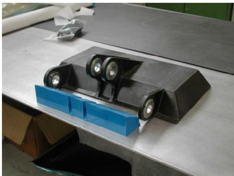
圖 23、可溶性纖維材料應用於擾流板接頭製作
