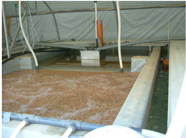
新建高密度養殖池第一段外觀及其流動床處理槽
