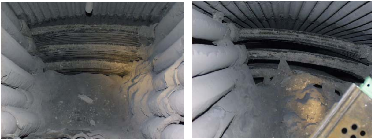
圖 38、左圖為黏著性飛灰堵塞，右圖為絨毛性飛灰堵塞
