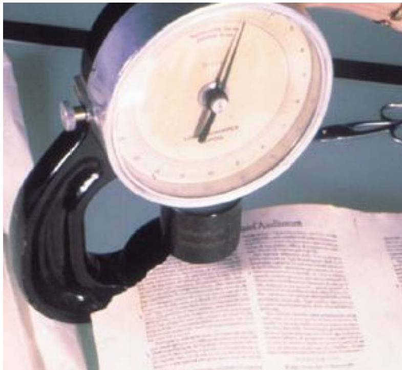
圖 3-3-8 紙厚測量 (ICPL) (資料來源 ICPL 網站)
