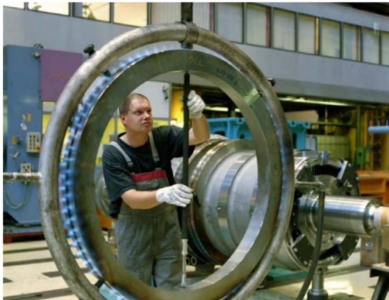
圖十九 汽輪機內殼縮環以環狀瓦斯加熱器加熱膨脹
