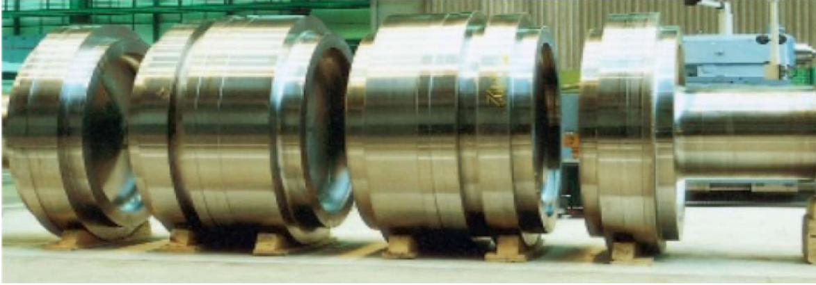
圖廿六 汽輪機轉軸分段製造焊接組合設計
