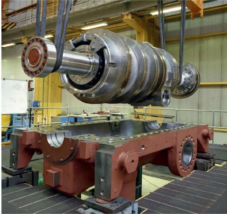
圖二十 內殼及轉子吊入汽輪機外殼下半部情形
