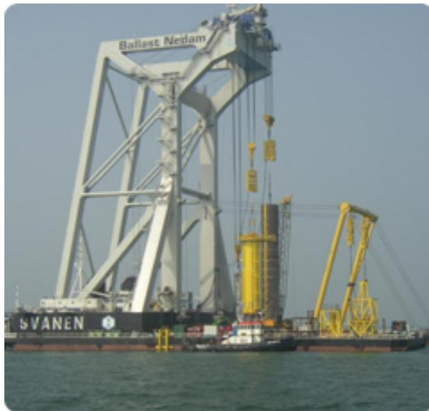
圖 4.5.(2).6 風機設置之施工船隻
