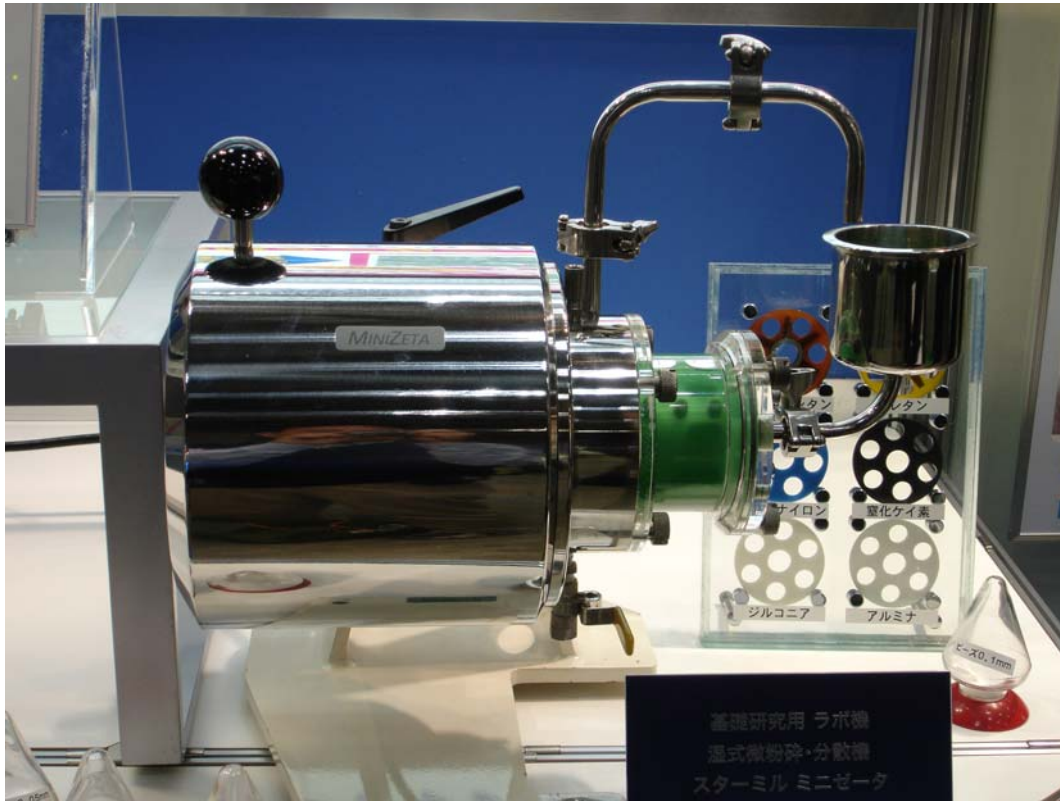
圖十一、日本 Ashizawa 公司與德國 NETZSCH 公司所開發之粉體 研磨機實體
