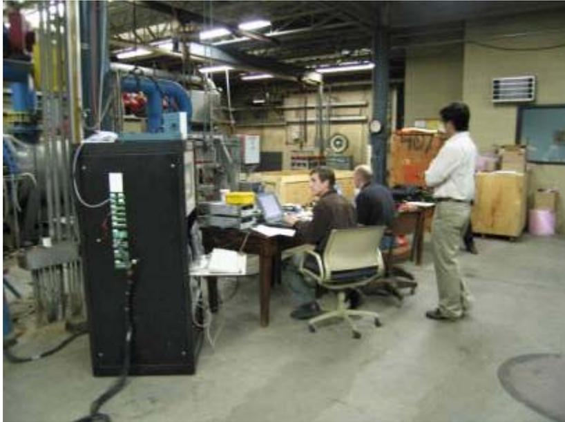
測試人員包括 Cameron 公司 4 員、代理商富迪斯公司直接由台灣派 1 員，以及 Alden 實驗室相關人員（至少 5 員）參與，執行校驗測試設備之安裝、測試迴路之水流量控制、測試數據之收集、測試數據之分析等。因測試時間快接近聖誕節，Cameron 公司與 Alden 實驗室技術人員為能提前回家，每天早上從 6 點就開始進行校驗測試，直到晚上 8 點為止。測試期間同團人員隨時皆可至現場參觀，並詢問測試人員相關問題或者拍攝照片；富迪斯公司的技術員與核二廠儀控課劉股長亦趁機學習拆解與安裝 Transducer，以及連接相關傳輸線路；Alden 實驗室 Dr. James B. Nystrom 亦曾簡報 Allen 校驗測試設備，包括：設備介紹、流量的量測、測試的不準度、影響不準度的因素、符合相關的法規、測試的可追溯性、測試的可重複性等（附件四）。
