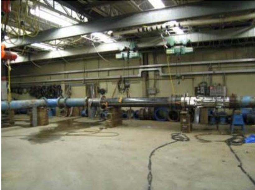
1、在 LEFM 流量計上游管路使用不同之流體力學模式測試，以確認其是否受不同之流動速度輪廓（Flow Velocity Profile）而影響其精準度。
