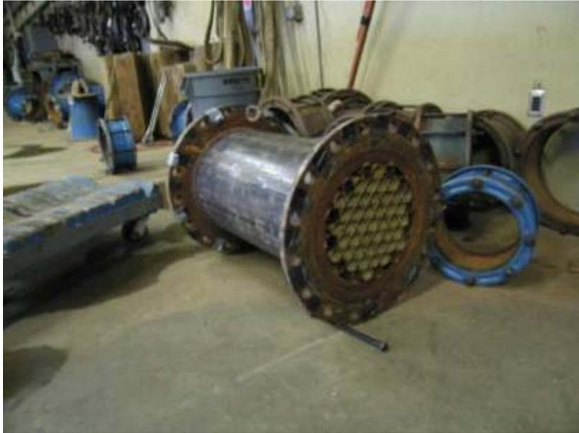
(3) 將 LEFM 流量計旋轉 90 度直立安裝 (Transducer 垂直於地面)。
