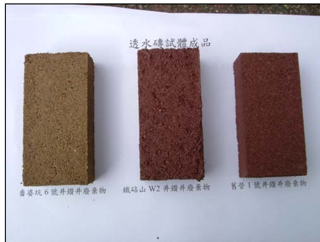
圖 9 利用各鑽井廢棄物燒製成之透水磚成品
