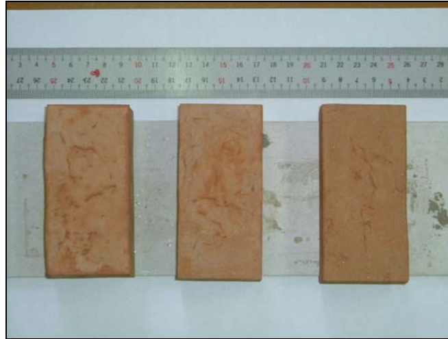
圖 8 利用鑽井廢棄物資源化製作建築用普通磚試體磚成品
