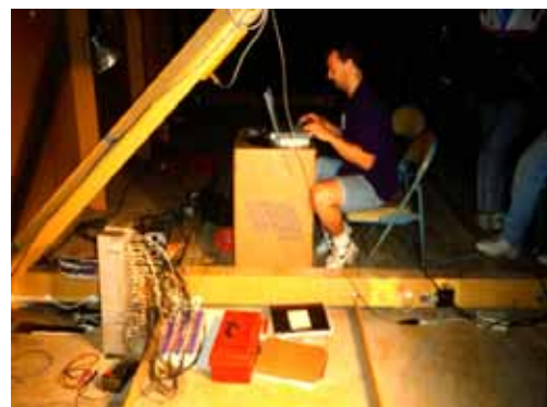
音響放射測量技術和應變計監測(CalTrans提供)
