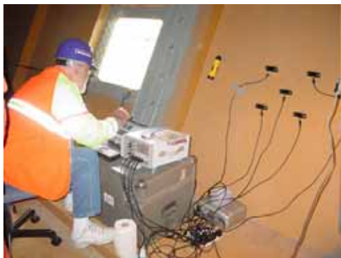
音響放射測量技術和應變計監測(CalTrans提供)
