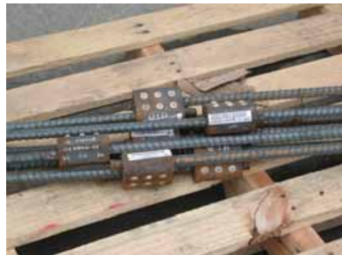
鋼筋續接器試驗(二)
