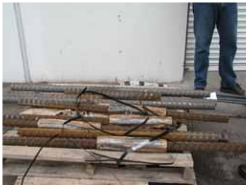
鋼筋續接器試驗(一)
