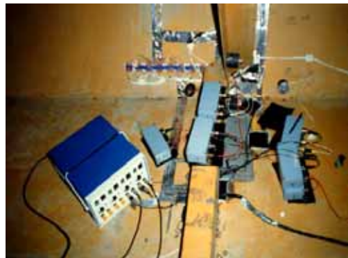
音響放射測量技術和應變計監測(CalTrans提供)
