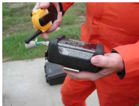
進入箱梁內部前利用 Micro MAX Pro 廢氣偵測
