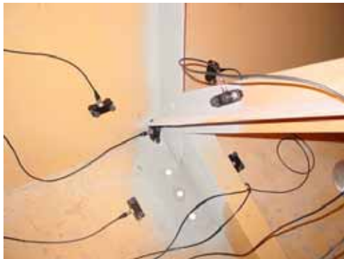
音響放射測量技術和應變計監測(CalTrans提供)
