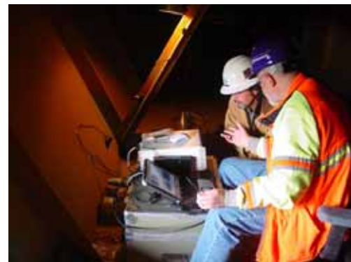
音響放射測量技術和應變計監測(CalTrans提供)
