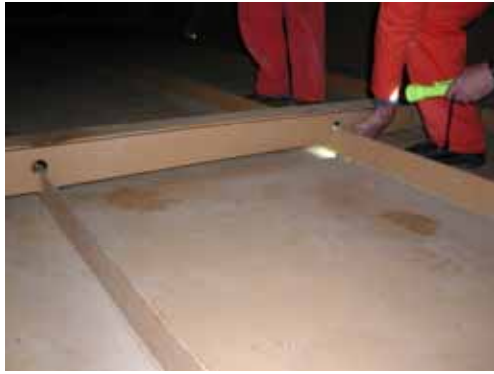
底下橫向框架加勁版連接處有裂縫
